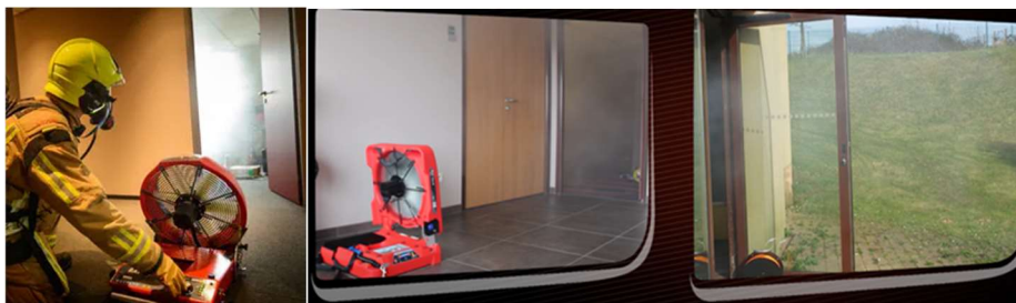
Рисунок 4 – Нагнітання свіжого повітря в задимлене приміщення
