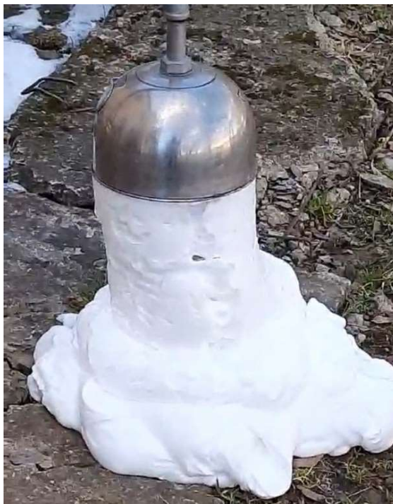
Рисунок 3 – Загальний вигляд компресійної піни, яка була згенерована через насадку заспокоювач
