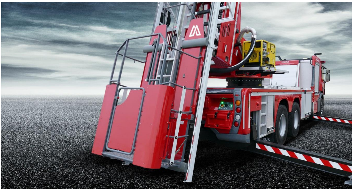
Рисунок 1 – Рятувальний ліфт вантажопідйомністю 300 кг, який встановлений на автодрабині Magirus M68L
