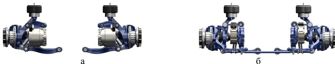
Рисунок 1 – Електричні мости моделі IDS LF-225 з незалежною підвіскою одинарних коліс: а) – тяговий; б) – тягово-керований
