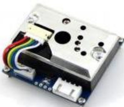
Рисунок 5 – Зображення модуля датчику пилу GP2Y1010AU0F
