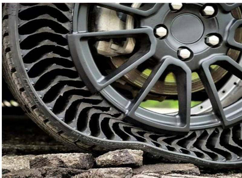
Рисунок 2 – Зовнішній вигляд безповітряної шини Michelin Uptis
