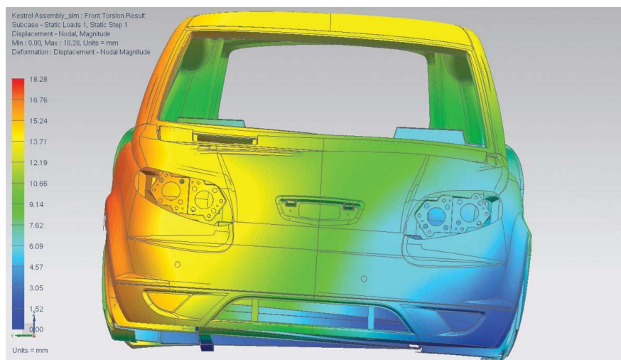
Рисунок 1 – Приклад результату розрахунку передньої частини кузова на кручення.
