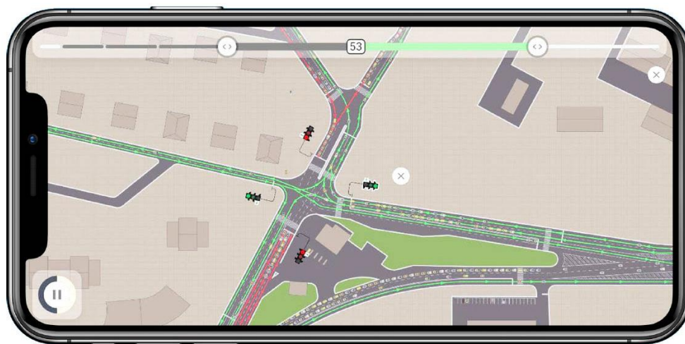
Рисунок 3 – Налаштування режимів роботи світлофора на реальному перехресті у м. Харкові біля метро Київська.
