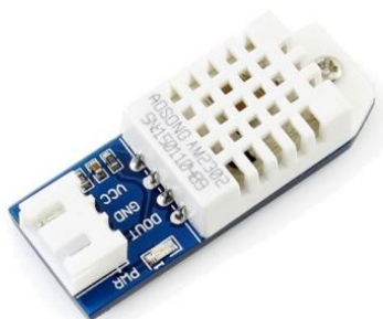
Рисунок 6 – Зображення модуля датчика температури та вологості повітря DHT22
