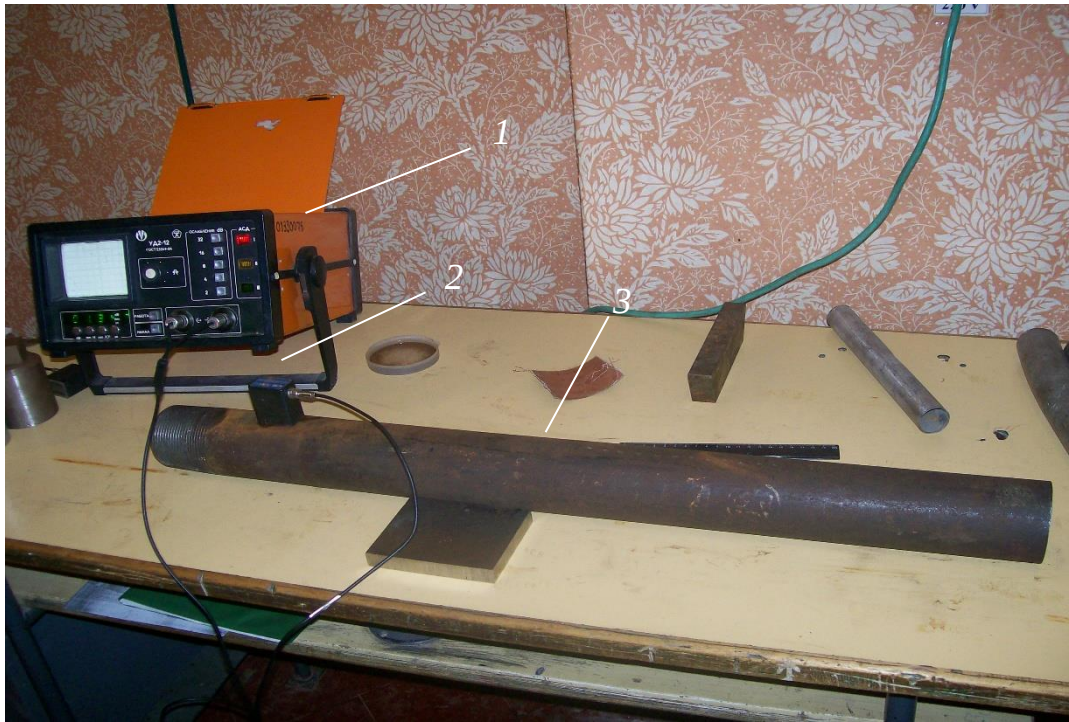
Рис. 1. Стенд для дослідження сталеві труби з різьбою: 1 – дефектоскоп УД2-12; 2 – ПЕП; 3 – сталеві труба з різьбою.
