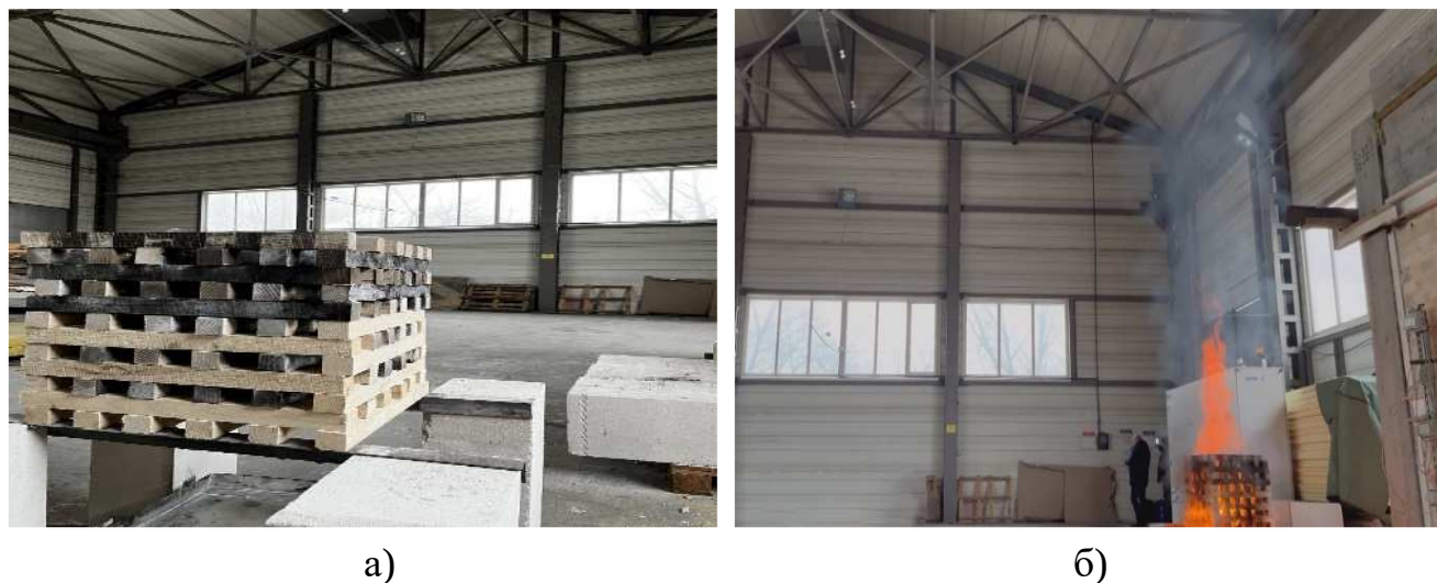
Рисунок 5.20 – Експериментальне дослідження часу спрацювання адресного пожежного сповіщувача : а) модельне вогнище для проведення експерименту; б) виконання експерименту [99]
