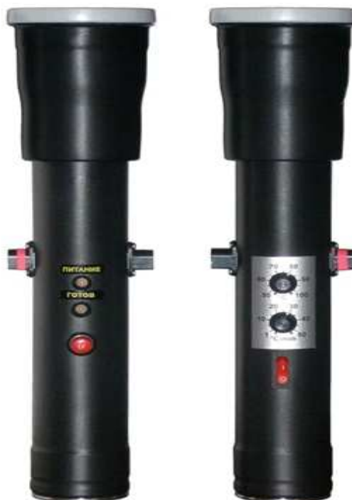
Рисунок 1.8 – Зовнішній вигляд пристрою Теплотест-М, модель H211 (зображення взято з сайту: http://www.elfor.ck.ua/produkt/h211 )
