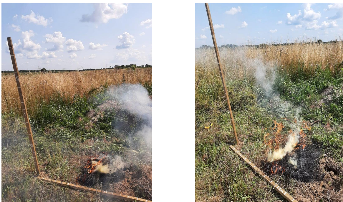
Рисунок 4.10 – Експериментальні дослідження висоти полум'я під час горіння лучної рослинності
