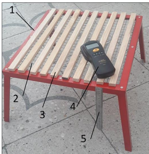
Рисунок 4.3 – Прилад для визначення пожежної небезпеки в лісових масивах та природних екосистемах за умовами погоди: 1 – рама для кріплення елементів; 2 – металева сітка; 3 – дерев’яні бруски; 4 – вологомір деревини; 5 – металева лінійка (автори Попович В.В., Волощишин А.І., Гапало А.І., 2018 р.)
