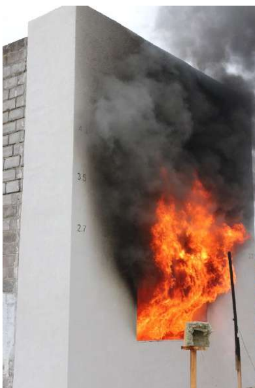
Рисунок 4.9 – Вид фрагмента на 30-ій хвилині випробувань
