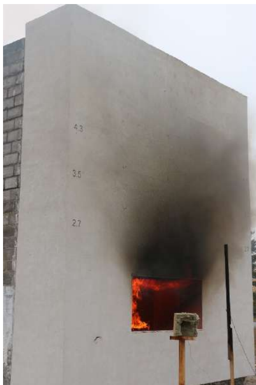
Рисунок 4.4 – Вид фрагмента на 5-ій хвилині випробувань
