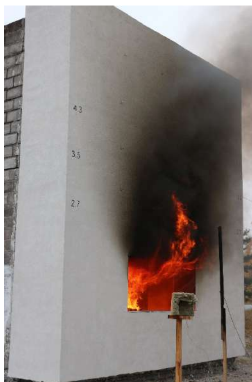
Рисунок 4.5 – Вид фрагмента на 10-ій хвилині випробувань
