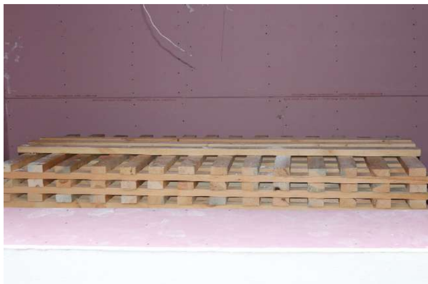
Рисунок 4.3 – Вид штабеля брусків з деревини крізь віконний проріз у вогневій камері
