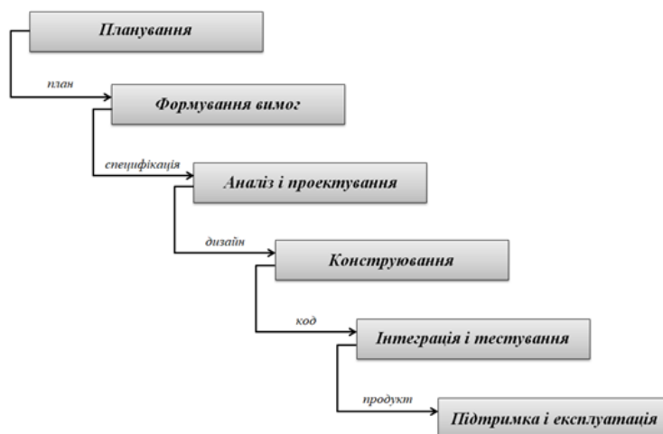
Рисунок 1.1. – Життєвий цикл моделі Waterfall [28]
