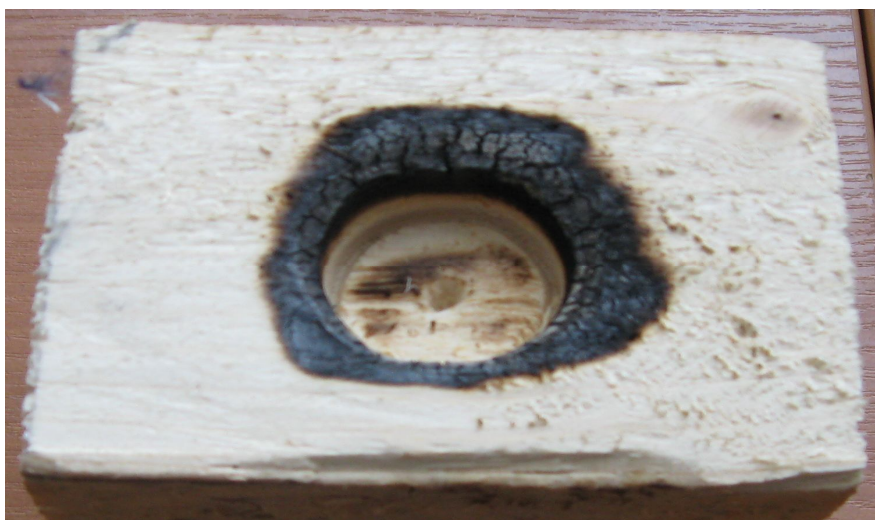
Рис. 1 - Вид термических поражений образца древесины
