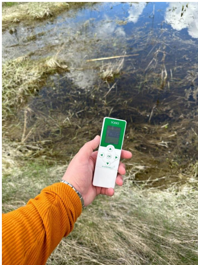
Рисунок 3.19 – Процес вимірювання радіаційного фону поблизу техногенної водойми біля підніжжя породного відвалу
