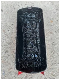
Рисунок 1 – Розрізаний корпус вогнегасника з тріщиною у внутрішньому полімерному покритті після витримки в ньому розчину
