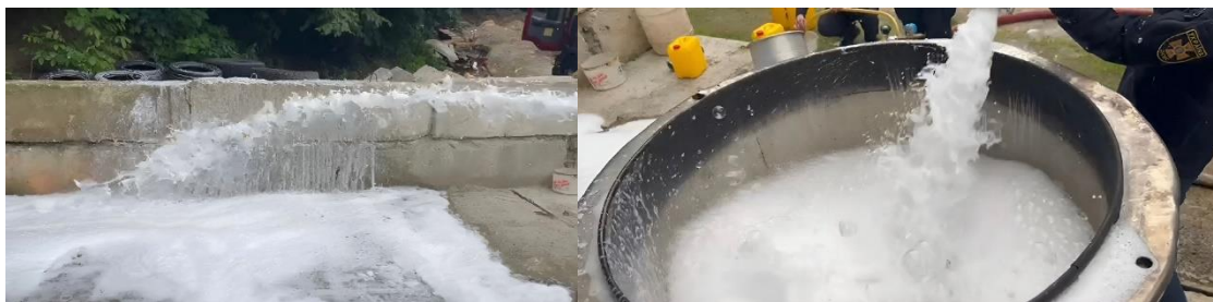
Рис. 4.3. Подавання піни від пожежної автоцистерни з використанням переносного пінозмішувача
