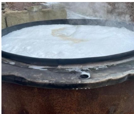
Рис. 3.9. Загальний вигляд компресійної піни на поверхні горючої рідини після гасіння пожежі в макетному резервуарі.
