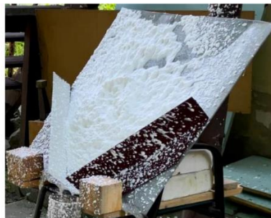
Рис. 3.2. Піноприймач для визначення кратності та стійкості піни: 1 – зливний пристрій
