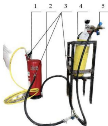
Рис. 3.3. Лабораторна установка типу вогнегасника для генерування компресійної піни: 1 – корпус вогнегасника (посудина для змішування води та ПУ); 2 – з'єднувальні шланги; 3 – запірні вентиля; 4 – балон із стиснутим повітрям; 5 – редуктор із манометром
