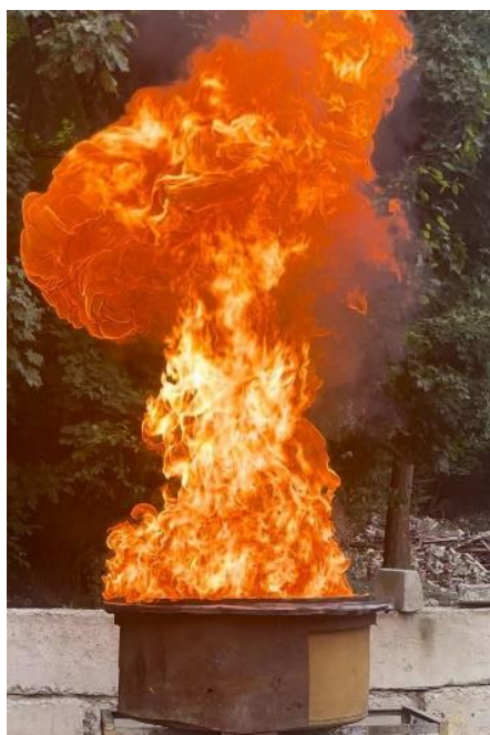
Рис. 3.8. Загальний вигляд макетного резервуара після підпалу горючої рідини
