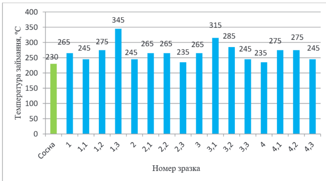
Рис. 8. Результати експериментальних досліджень із визначення температури займання
