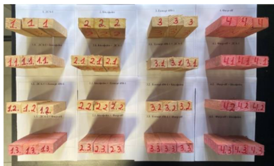
Рис. 1. 48 зразків, що просочені вогнезахисними засобами ДСА-1, Біофлейм, Ecosept 450-1, Фаєр-офф окремо кожним засобом і надалі в різних комбінаціях заміни вогнезахисного засобу
