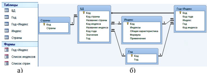
Рисунок 1 – Структура БД: а) таблицы и формы; б) связи между таблицами
