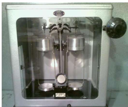
Рисунок 2. – Аналітичні ваги типу АДВ-200М Джерело: фото авторів як продовження власних досліджень
