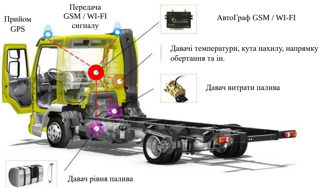
Рисунок 2 – Приклад встановлення обладнання для дистанційного моніторингу технічного стану автомобілів
