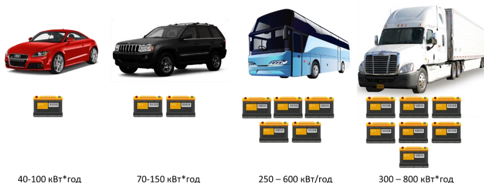
Рисунок 2 – модульний принцип заміни акумуляторних батарей для різних типів транспортних засобів
