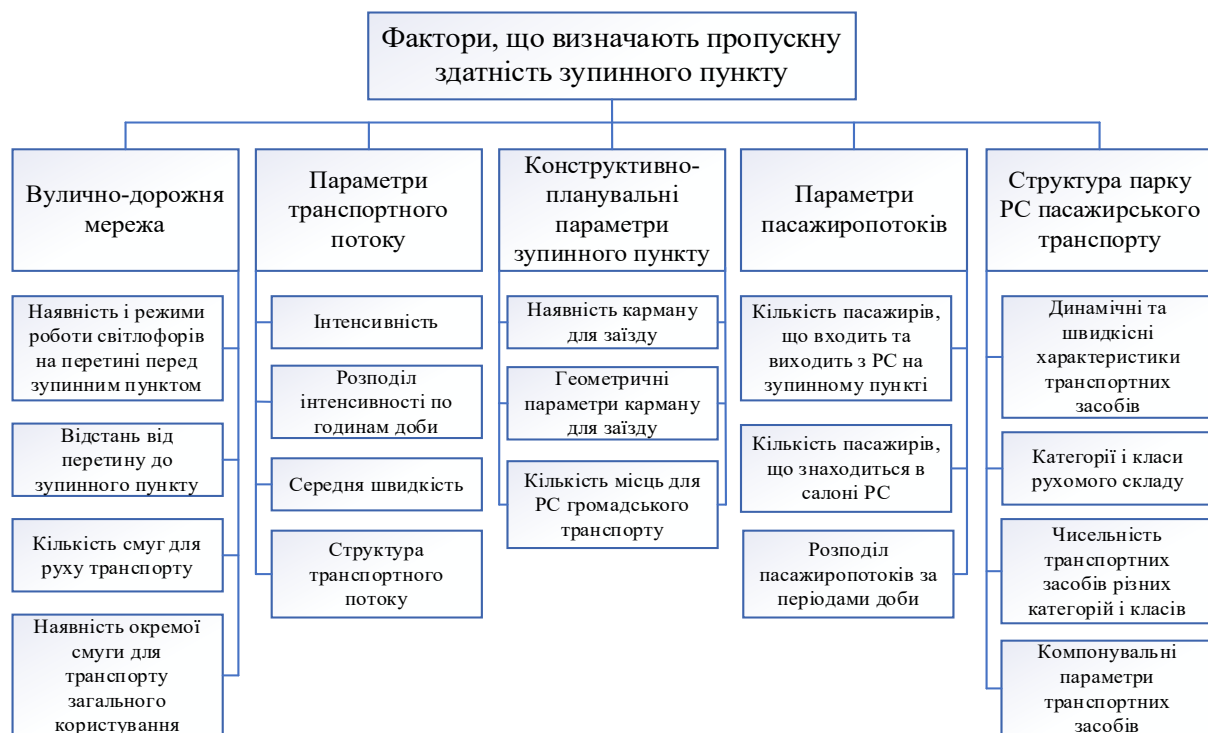
Рисунок 1 – Схема факторів, що визначають пропускну спроможність зупинного пункту МПТ
