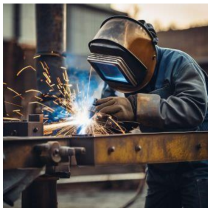
Рис. 3. Використання засобів індивідуального захисту під час зварювання [1]
