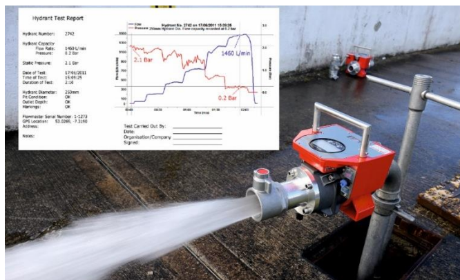
Рисунок1 – Фото роботи приладу Flowmaster 250 та зразок звіту по проведеній перевірці працездатності
