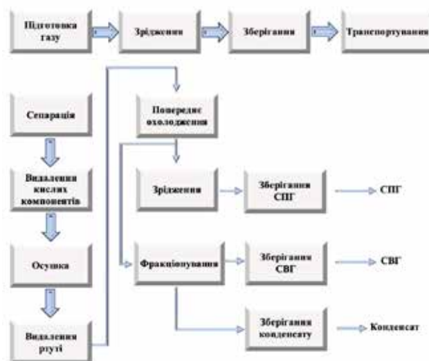
Рис. 4. Схема технологічного процесу виробництва СПГ
