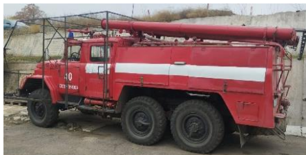
Рисунок 1 – Захисний сітковий контур на автоцистерні.
