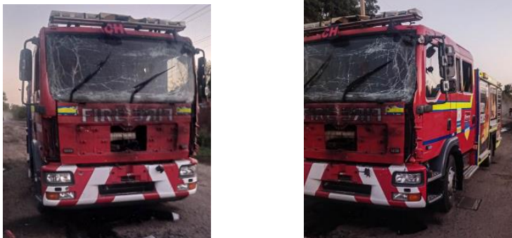
Рисунок 2 – Автоцистерна після ураження FPV дрона на оптоволокні.
