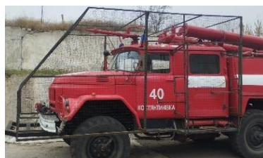
Рисунок 1 – Захисний сітковий контур на автоцистерні.
