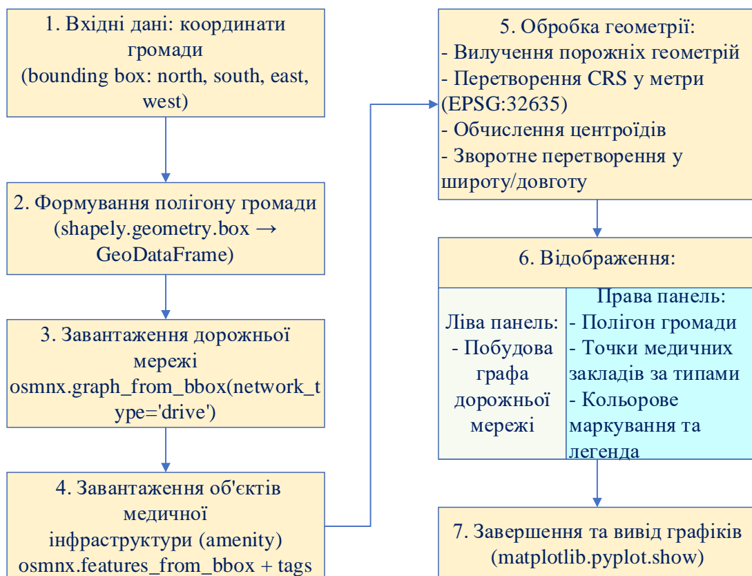
Рисунок 3.7 – Схема модуля для завантаження геопросторових даних з відкритого картографічного сервісу OpenStreetMap
