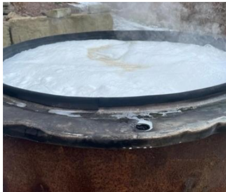
Рис. 2.7. Загальний вигляд компресійної піни на поверхні горючої рідини після гасіння пожежі в макетному резервуарі.
