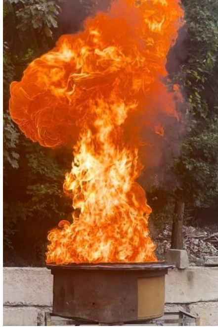
Рис. 2.6. Загальний вигляд макетного резервуара після підпалу горючої рідини
