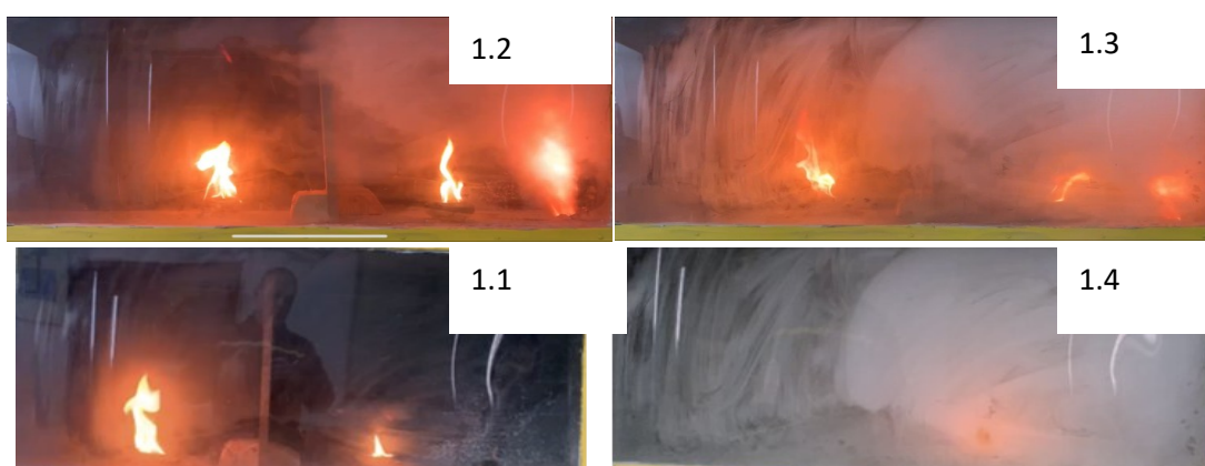
Рис. 3.2.1. Кінограма експерименту з визначення ефективності поширення аерозолю через 1 перегородку поз., (1.1. - початок експерименту; 1.2. - 5 секунда; 1.3 - 10 секунда; 1.4 - 13 секунда)
