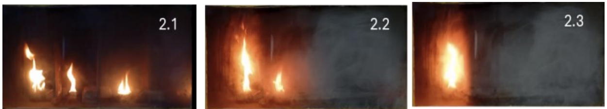
Рис 3.1.18. Кінограма експерименту з визначення ефективності поширення аерозолю через 3 перегородки виставлених у ряд. (2.1 - початок випробування; 2.2 - 7 секунда секунда; 2.3 - 10 секунда)
