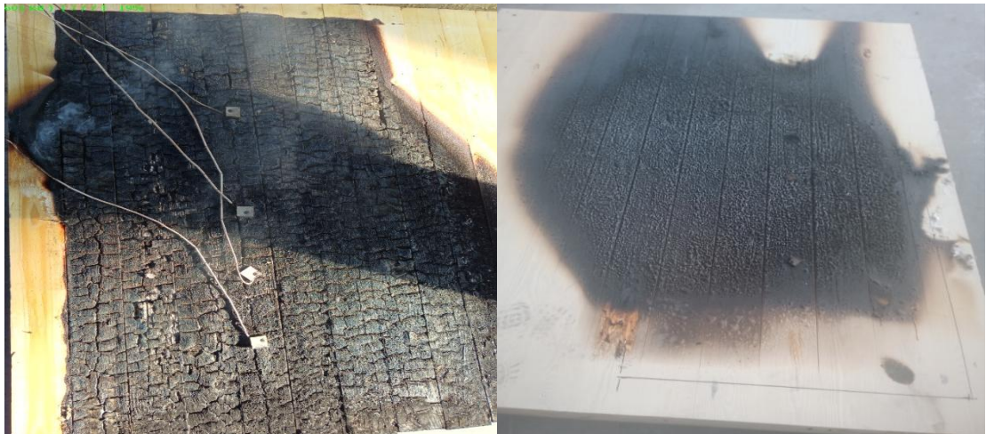
Рисунок 3.7 – Випробування на визначення межі поширення вогню згідно додатку «Д» до ДБН В.1.1-7-2016
