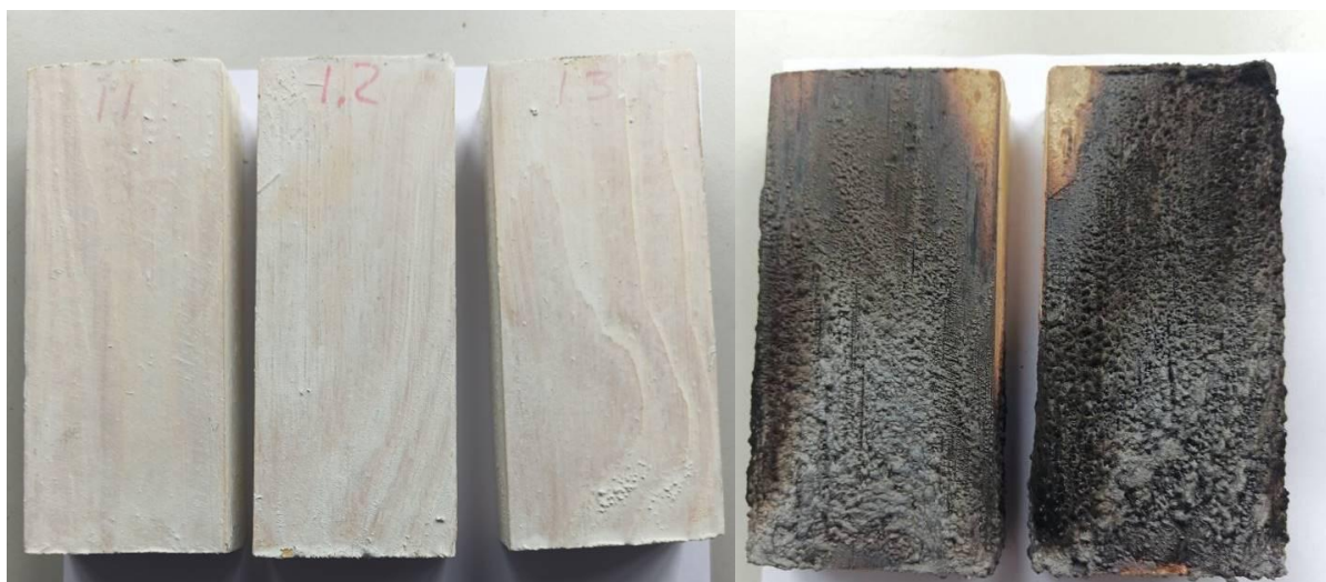
Рисунок 3.12 – Вигляд зразків захищених АМОК-1 на основі полівінілацетатного клею до початку випробування на визначення вогнезахисної ефективності (а) і після (б)
