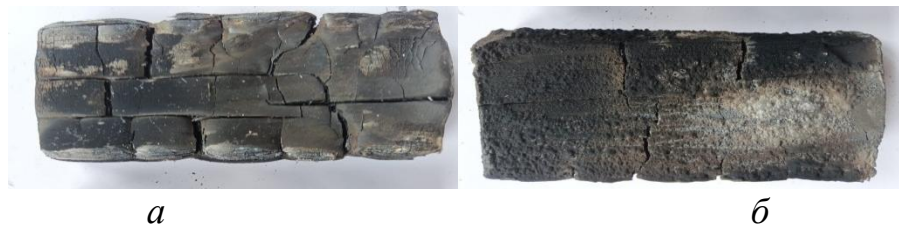
Рисунок 3.23 – Зразки деревини після випробувань: Зразки деревини після випробувань: а – необроблений зразок сосни; б – оброблений зразок сосни, час випробування 5 хв.
