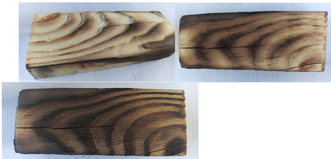
Рисунок 3.24 – Очищені зразки деревини обробленої вогнезахисною композицією АМОК-1 після випробувань в температурному режимі 5 хв.
