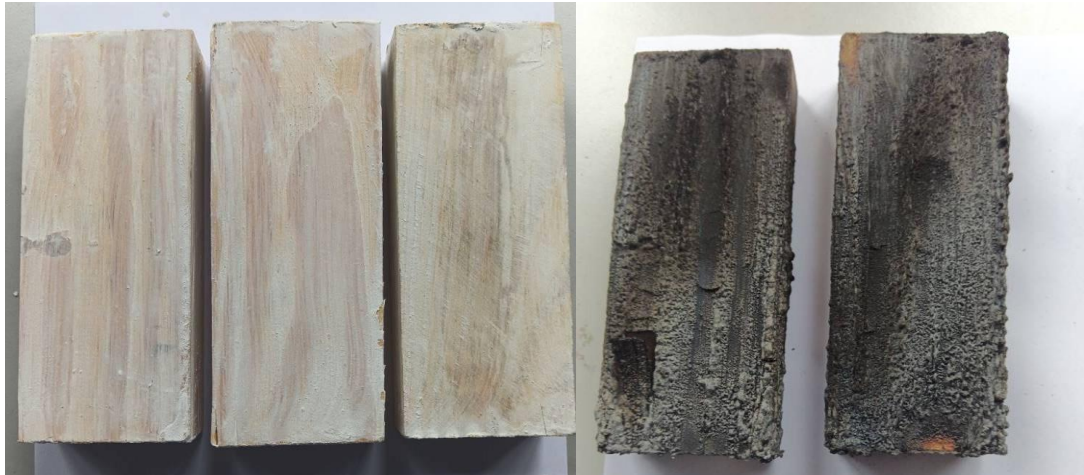
Рисунок 3.16 – Вигляд зразків захищених антипіреном на основі силікатного клею до початку випробування на визначення вогнезахисної ефективності (а) і після (б).
