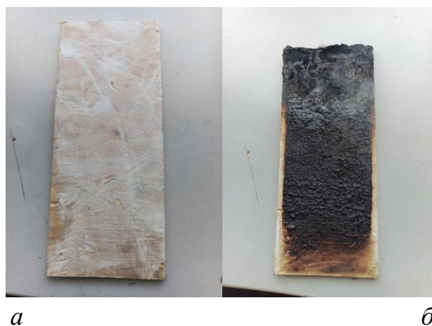
Рисунок 3.8 – Зразки деревини, оброблені антипіреном на основі полівінілацетатного клею: до проведення випробування (а) та після його завершення (б)
