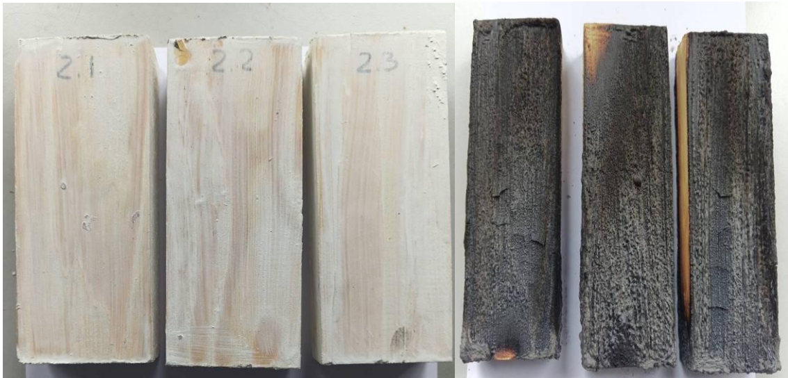
Рисунок 3.14 – Вигляд зразків покритих антипіреном на основі полівінілацетатного клею до початку випробування на визначення вогнезахисної ефективності (а) і після (б)
