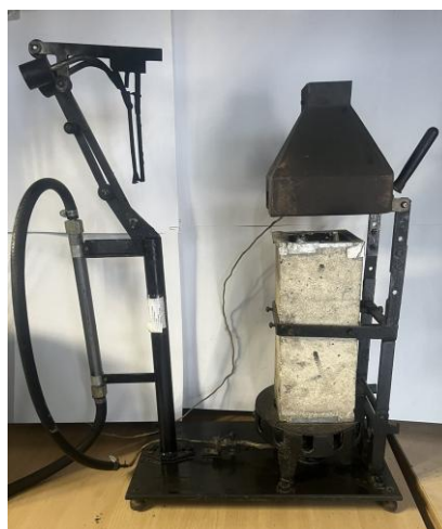
Рисунок 3.2 – Випробувальна піч згідно ГОСТ 16363-98
