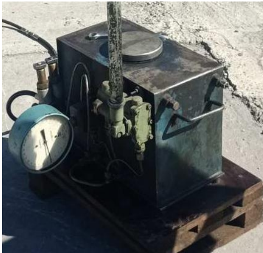
Рисунок 3.10 – Гідравлічне обладнання для навантаження конструкцій: а - гідронасосна станція; б - гідравлічні домкрати 400 \text{ тс/м}^2
