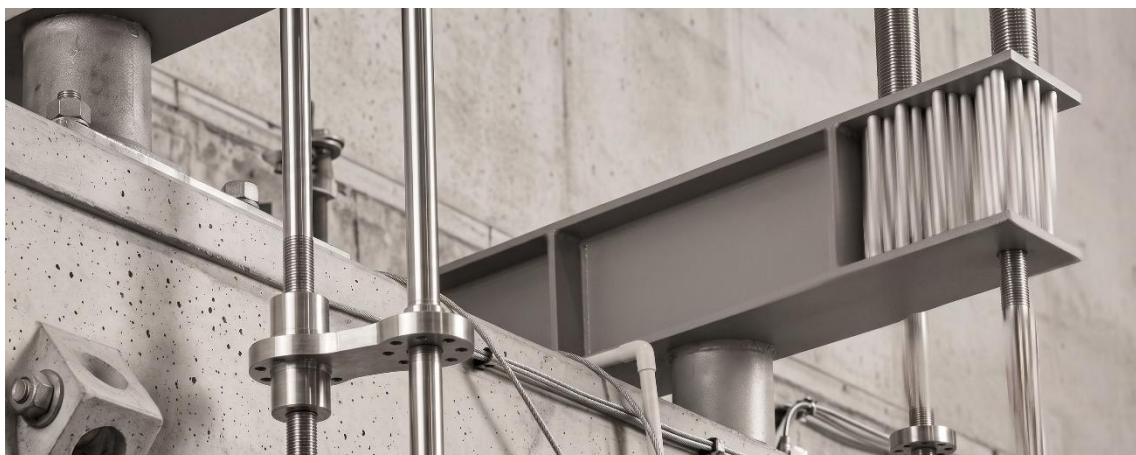
Рисунок 3.13 – Горизонтальні траверси із встановленими гідравлічними домкратами
