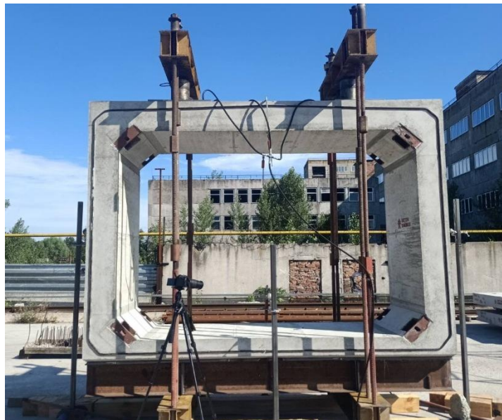
Рисунок 3.14 – Зразок секції захисного укриття ЛШСС-1 встановлений у вузол для механічних випробувань
