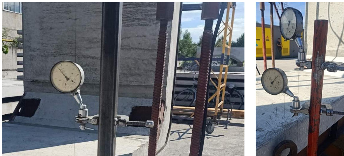
Рисунок 3.16 – Положення прогиномірів на встановленій у опорно-навантажувальну систему зразка секції укриття
