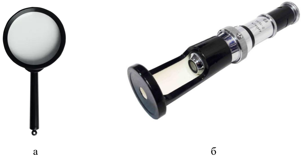
Рисунок 3.6 – Набір оптичного обладнання для вимірювання розмірів особливостей матеріалів конструкцій:
