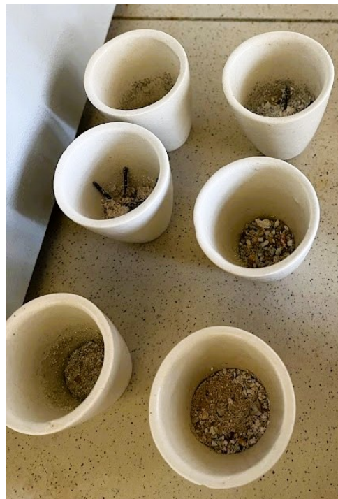
Рисунок 4.2 – Прокалені зразки твердого піролізного залишку
