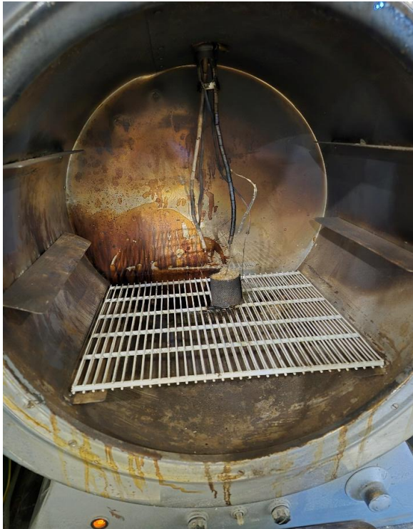
а) Теплова камера із зразком для визначення теплових умов самозаймання
