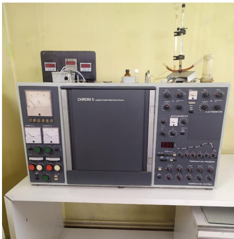
Рисунок 2.3 - Газовий хроматограф «Хром-5», встановлений у науково-дослідній лабораторії пожежної безпеки
