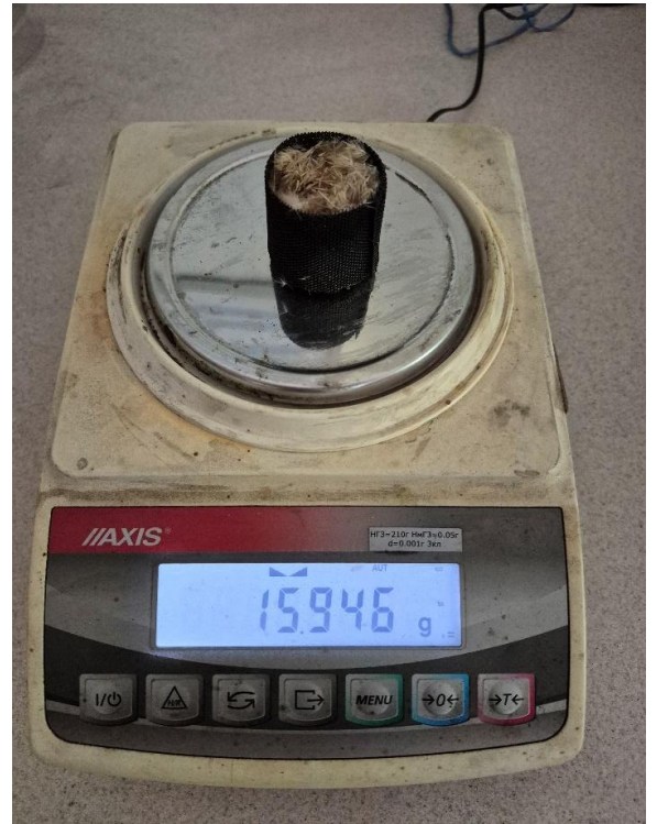
б) Корзина для зразка (питома поверхня 171 \text{ м}^2 )
