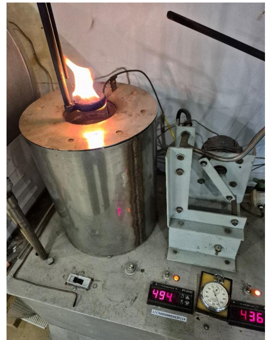
г) Прилад для визначення температури самозаймання твердих речовин і матеріалів
