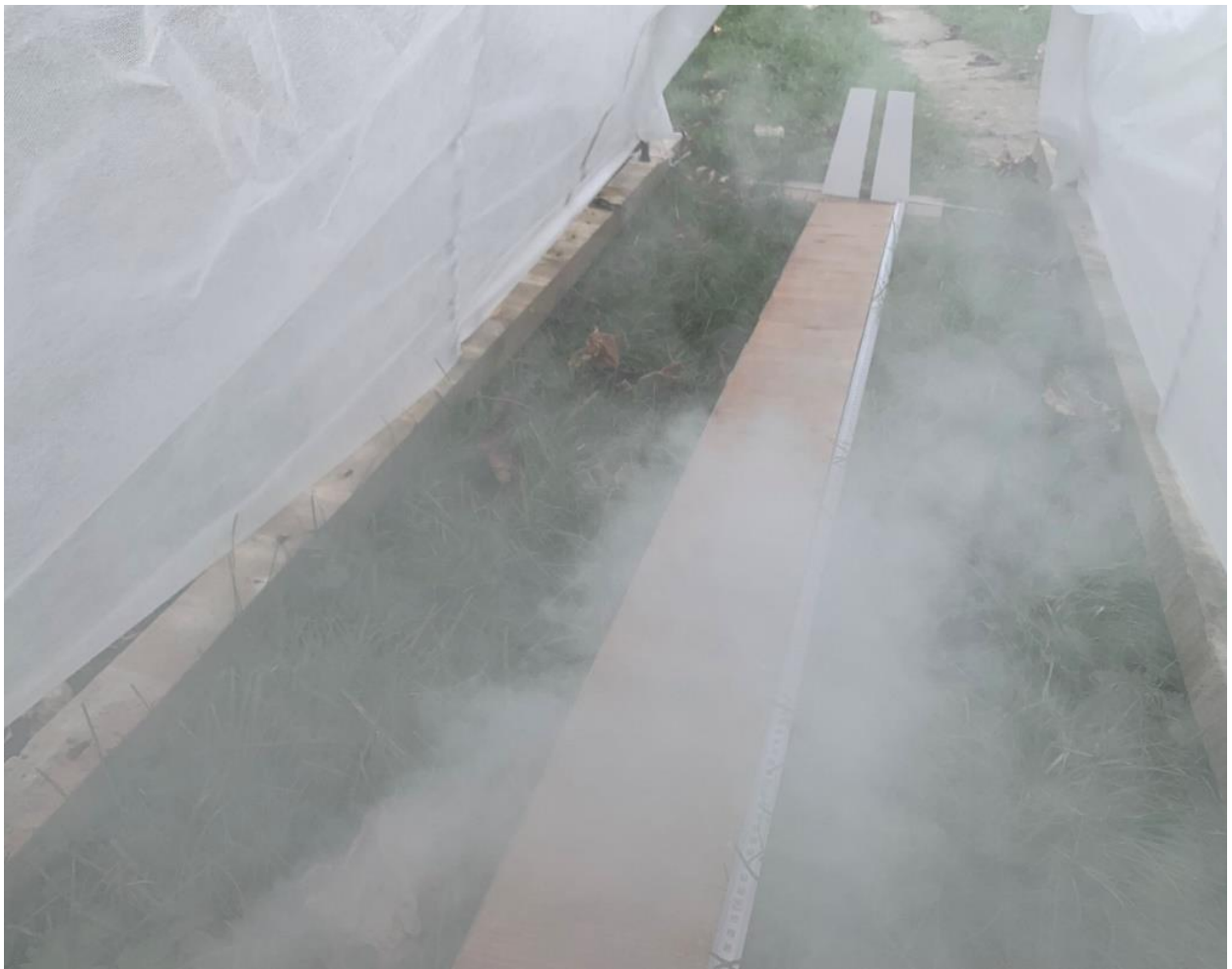
Рисунок 2.1 – Експериментальний тунель для досліджень роботи лідара у задимленому просторі
