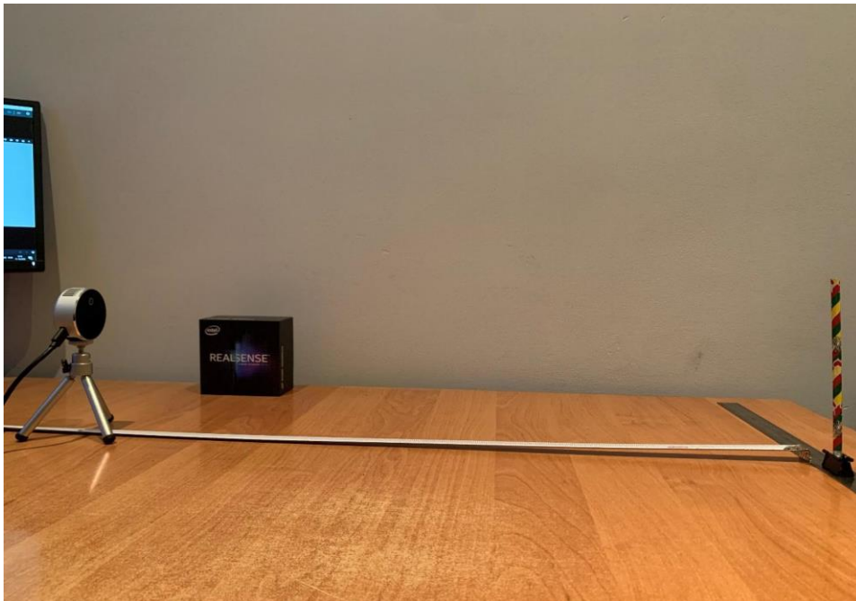
Рисунок 3.3 – Експериментальне дослідження методу підвищення чутливості та покращення якості зображення лідара, об'єкт – циліндр діаметром 7 мм і довжиною 170 мм Джерело: фото автора
