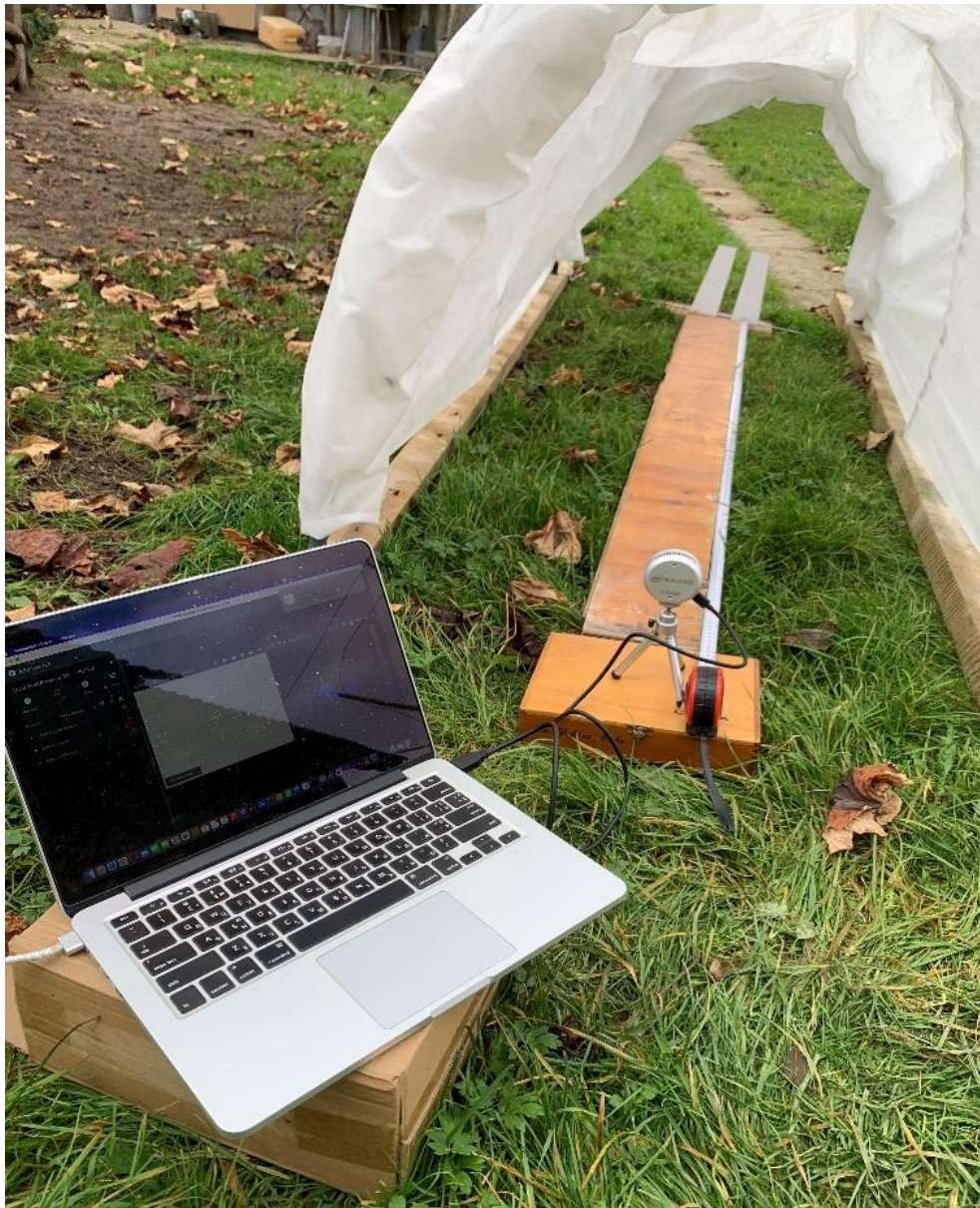
Рисунок 2.2 – Лідар під час досліджень в експериментальному тунелі циліндричної форми за відсутності задимлення
