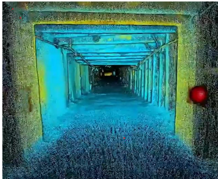
Рисунок 1.3 – Зображення, побудоване за допомогою лідара Velodyne та програмного забезпечення VeloWiew [42]
