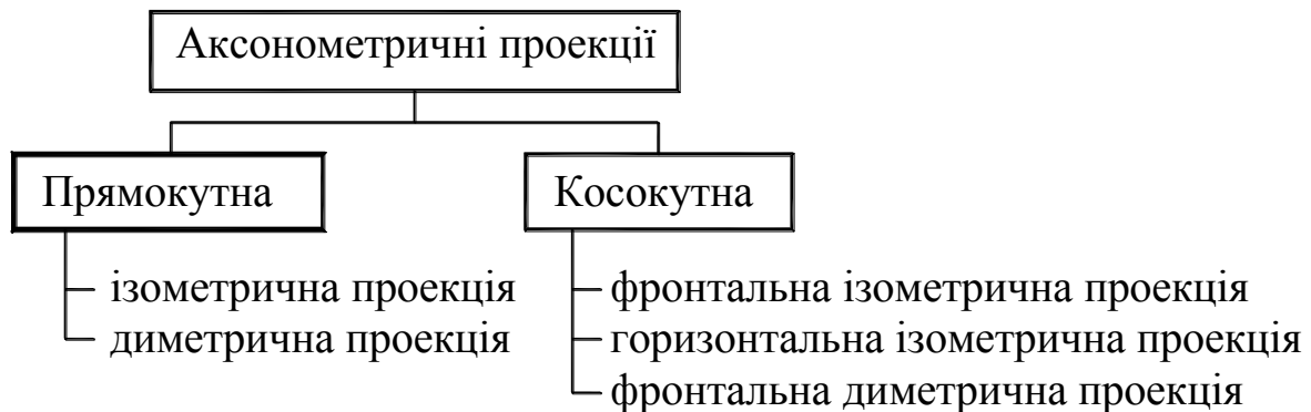
Рисунок 5.1 – Структура аксонометричних проєкцій
