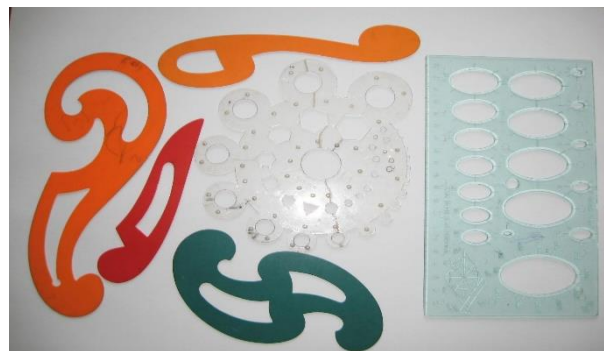
Рисунок 1.2 – Трафарети для виконання креслеників
