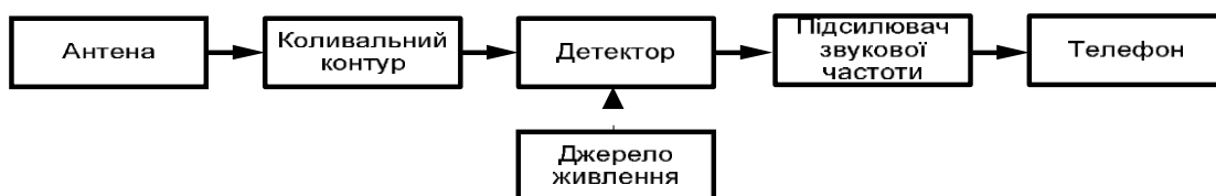
Рисунок 6.2 – Структурна схема радіоприймального пристрою
