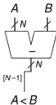
Рисунок 9.2 – N -розрядний компаратор величини
