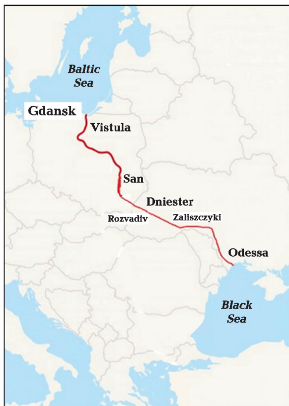
Рис. 1. Схема запропонованого Балтійсько-Чорноморського водного шляху на карті Європи. Тоншою лінією вказана та частина водного шляху, що потребуватиме наповнення русла річки та проходить територією України.
