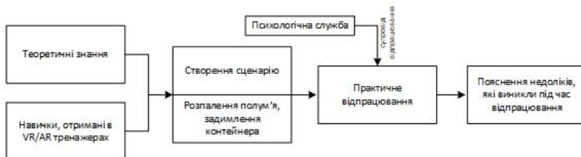
Рисунок 5 – Схема використання тренажерів контейнерного типу в навчальному процесі
