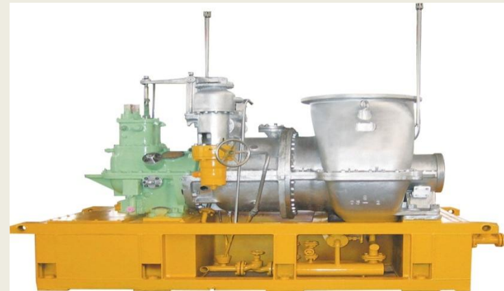
Рис.2 – Паровая конденсационная турбина: Номинальная мощность, кВт.....100 ÷ 1000 Номинальное давление пара, МПа .....до 3,9 Расход пара, т/ч .....3÷6,5
