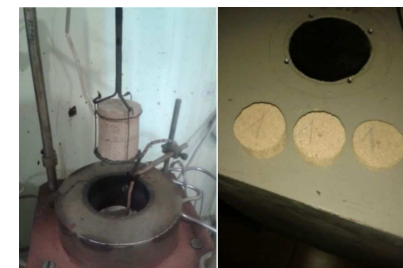
Рис. 3. Випробування вермикуліто-силікатної плити: а) фрагмент № 1 до випробування; б) фрагмент № 1 після випробування
