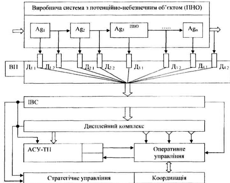
Рис 1. Схема ієрархічного управління.
