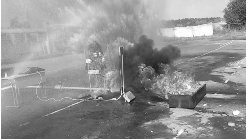
Рис. 1. Процес дослідження коефіцієнта екранування радіальною водяною завісою
