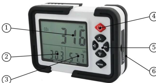
Рис. 2.3 – Портативний детектор CO 2 – термогігрометр типу HT-2000: 1 – показання концентрації CO 2 , ppm; 2 – температура, °C; 3 – відносна вологість, %; 4 – кнопка увімкнення; 5 – кнопки керування (одиниці температури °C/°F, сигналізація ALM, підсвічування, запис REC, вибір режиму MODE); 6 – бічний відсік з роз'ємом USB
