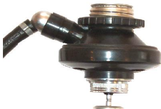
Рис. 2.21. Загальний вигляд легеневого автомата III-го типу
