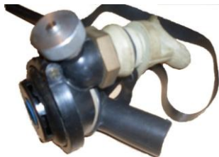
Рис. 2.17. Загальний вигляд легенєвого автомата I-го типу
