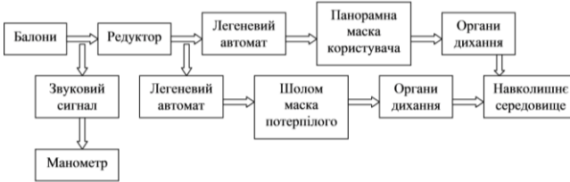
Рис. 2.8. Принцип роботи апарата АСВ-2 на прикладі блок-схем: а) блок-схема роботи апарата АСВ – 2 (I-го варіанта виконання); б) блок-схема роботи апарата АСВ – 2 (II-го, III-го варіантів виконання) з рятівним пристроєм
