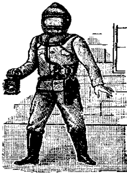
Рис. 1.10. Протидимний прилад Нейперта
