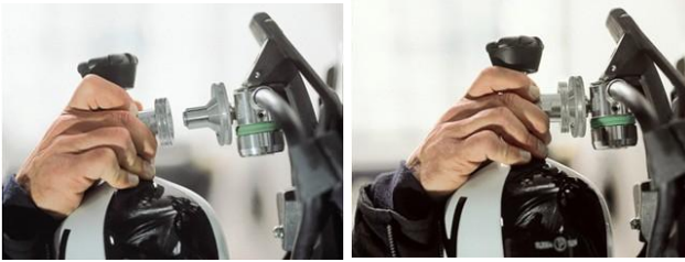
Рис. 1.21. Порядок підключення баллона за допомогою адаптера alpha CLICK
