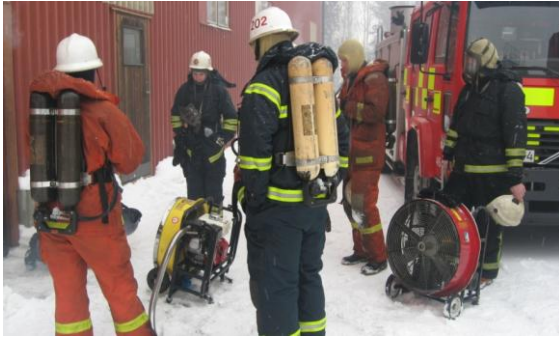
Рис. 7.11. Приклад застосування сучасного осьового пожежного димовисмоктувача
