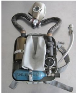
Рис. 4.1. Загальний вигляд протигаза КИП-8:
