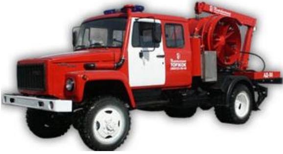
Рис. 7.20. Загальний вигляд автомобіля димовилучення АД-90 (ГАЗ-33086) ПМ-629
