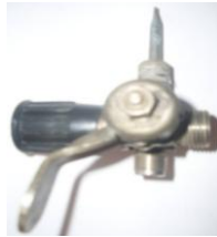
Рис. 2.9. Загальний вигляд вентиля з вмикачем резерву
