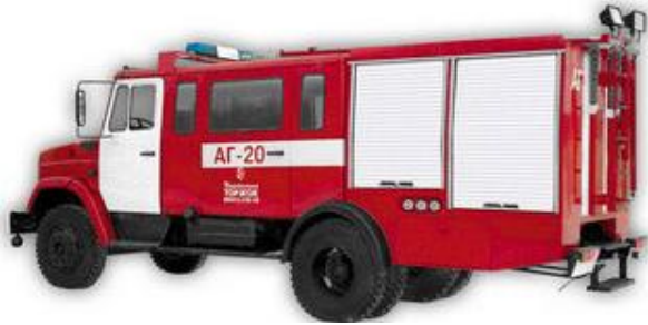
Рис. 7.16. Загальний вигляд автомобіля газодимозахисту АГ-20 (433362)
