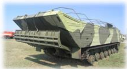
Рис. 1.29. ПТС-2 з обладнанням для самокопування та каркасом морського обладнання
