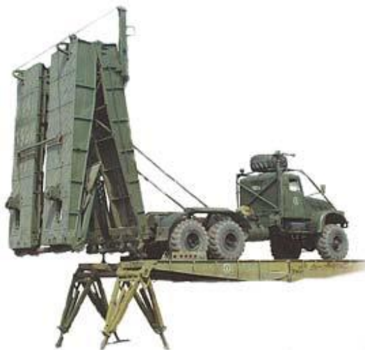
Рис. 1.18. Механізований міст ТММ-3
