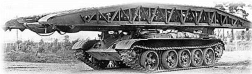
Рис. 1.3. Танковий мостоукладник МТУ
