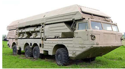
Рис. 1.13. Самохідні переправні засоби: а) ПТС-М; б) ПММ
