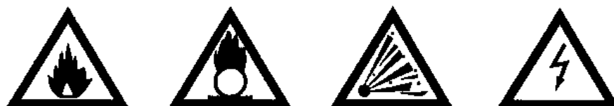
Рис. 3. Предупреждающие знаки: «Пожароопасно. Легковоспламеняющиеся вещества», «Пожароопасно. Окислитель», «Взрывоопасно: взрывоопасная среда», «Осторожно. Электрическое напряжение»
