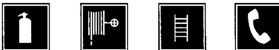
Рис. 5. Указательные знаки: «Огнетушитель», «Пожарный кран», «Пожарная лестница», «Телефон для использования при пожаре»
