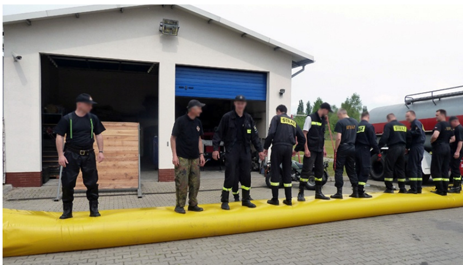
Rys. 3 Test wytrzymałości rękawów - 11 strażaków na rękawie (wyk. S. Dzedzianowicz)
