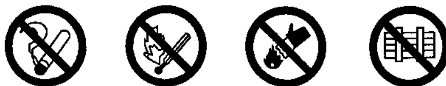
Рис. 2. Запрещающие знаки: «Запрещается курить», «Запрещается пользоваться открытым огнем», «Запрещается тушить водой», «Запрещается загромождать проходы»
