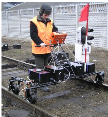
Rys. 3. Badanie defektoskopowe szyn w transporcie kolejowym
