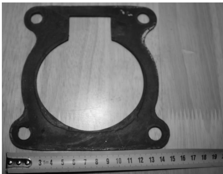
Рис.1.Прокладка ущільнювальна напірного патрубка пожежної помпи ПН – 40УВ
