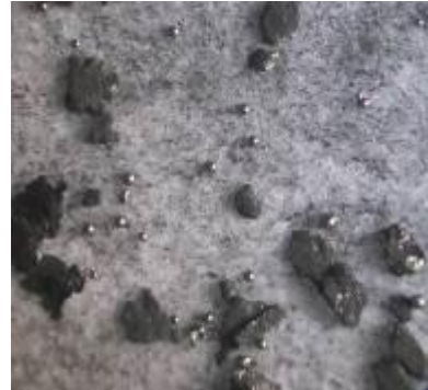
Рис. 3. Морфология частиц в порошках из шламов: а – фракция \le 50 мкм; б – фракция 50-100 мкм; \times 90
