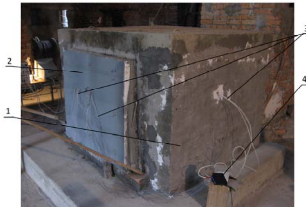
Рис. 3 Дослідна установка 1- Піч, 2- дослідний зразок, 3- термопари, 4- термоперетворювач
