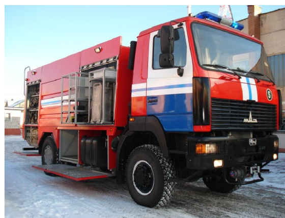
Рисунок 3 – Пожарные автоцистерны на базе шасси МАЗ-530905 с колесной формулой 4×4
