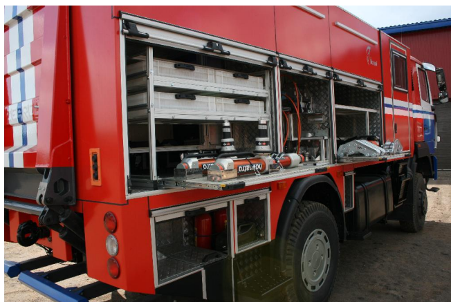
Рисунок 6 – Компоновочные решения для аварийно-спасательного автомобиля многофункционального назначения на базе полноприводного шасси МАЗ-530905
