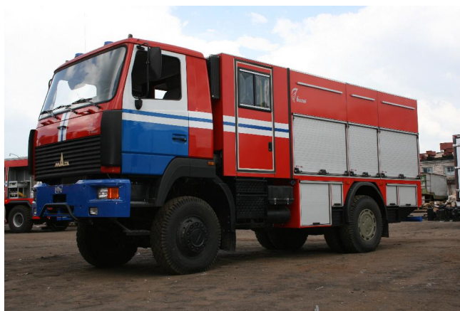
Рисунок 6 – Компоновочные решения для аварийно-спасательного автомобиля многофункционального назначения на базе полноприводного шасси МАЗ-530905
