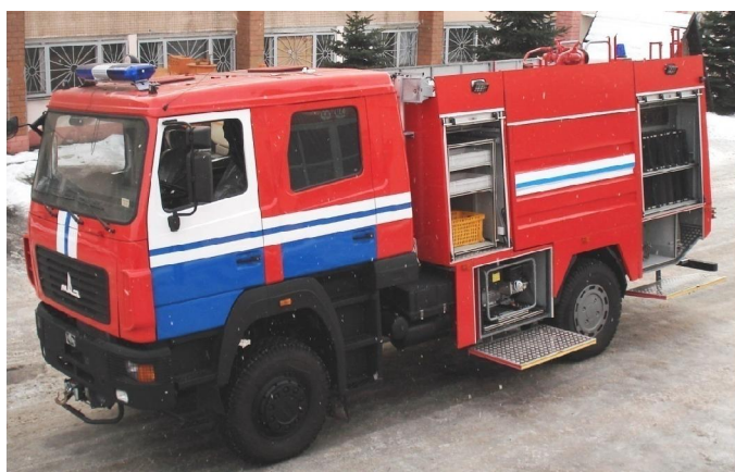
Рисунок 3 – Пожарные автоцистерны на базе шасси МАЗ-530905 с колесной формулой 4×4
