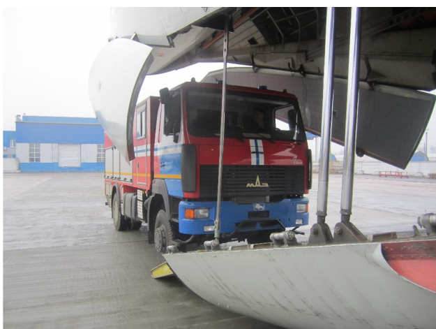
Рисунок 7 – Погрузка и размещение аварийно-спасательного автомобиля многофункционального назначения на базе полноприводного шасси МАЗ-530905 в грузовом отсеке воздушного судна ИЛ-76
