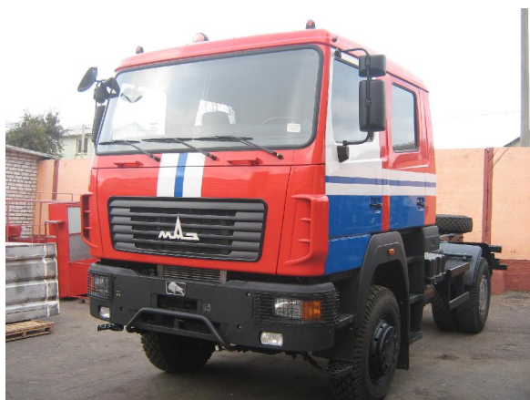
Рисунок 2 – Специализированное шасси МАЗ-530905 с колесной формулой 4×4
