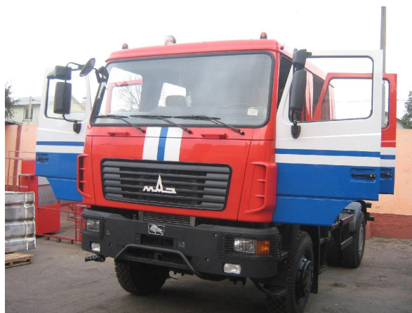
Рисунок 2 – Специализированное шасси МАЗ-530905 с колесной формулой 4×4
