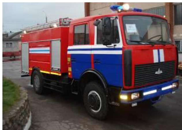
Рисунок 1 – Пожарные автоцистерны на базе шасси МАЗ-5337 и МАЗ-4370 с колесной формулой 4×2
