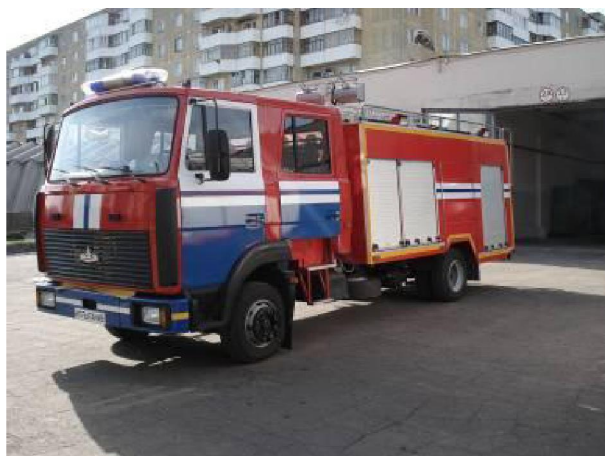
Рисунок 1 – Пожарные автоцистерны на базе шасси МАЗ-5337 и МАЗ-4370 с колесной формулой 4×2
