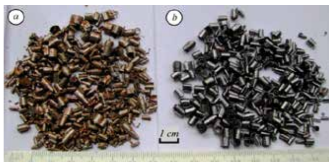
Rys. 4. Obrazy wiórów przechowywanych przez rok na powietrzu po procesie toczenia z chłodzeniem: a) wodą, b) CSCH ( v_c = 18 m/min)
