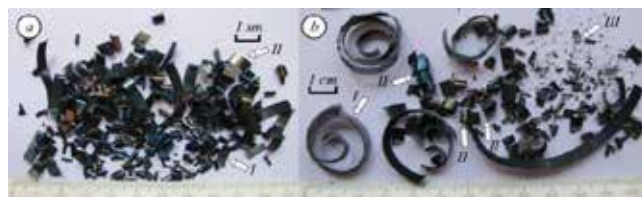
Rys. 1. Wióry przy toczeniu na sucho: a) v_c = 18 m/min, b) v_c = 28 m/min
