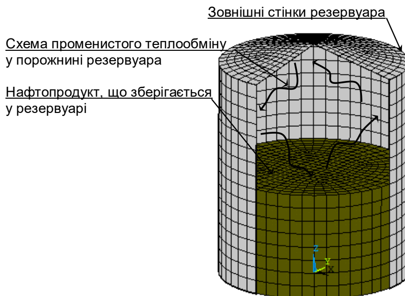
Рисунок 4.8 – Внутрішня будова резервуару та схема теплообміну у порожнині між стінками та дзеркалом рідини нафтопродукту
