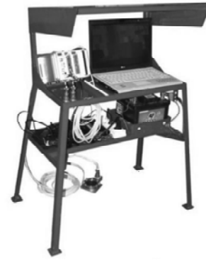
Figura 4. Test-controller-ul Q.Brixx gate cu moduli de măsurare
