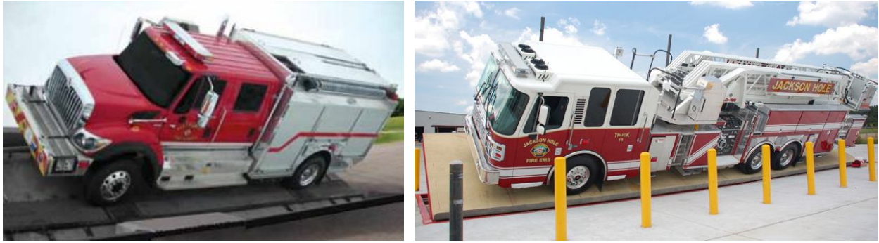
Рисунок 27 — Тестування шасі на поперечну стійкість
