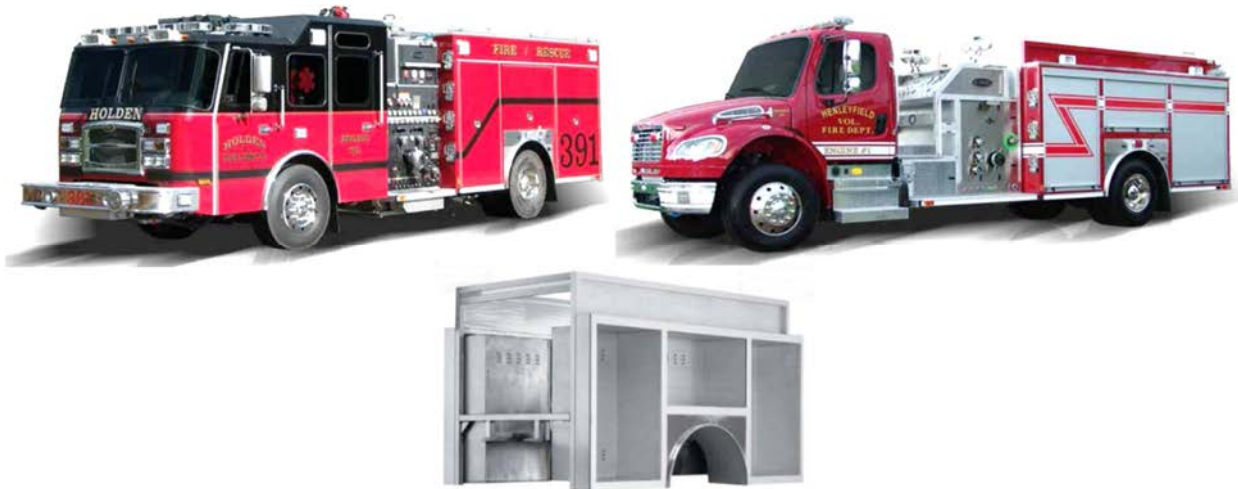
Рисунок 20 – Типова модульна надбудова та надрамник E-One
