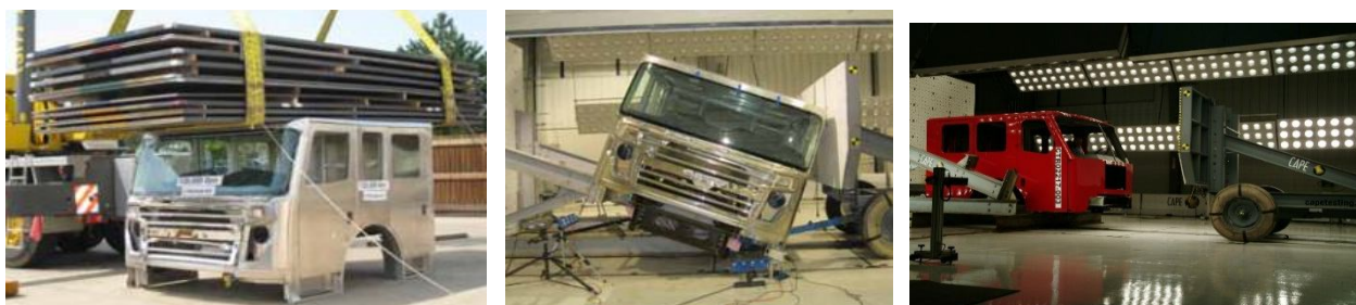
Рисунок 26 — Перевірка кабіни на міцність
