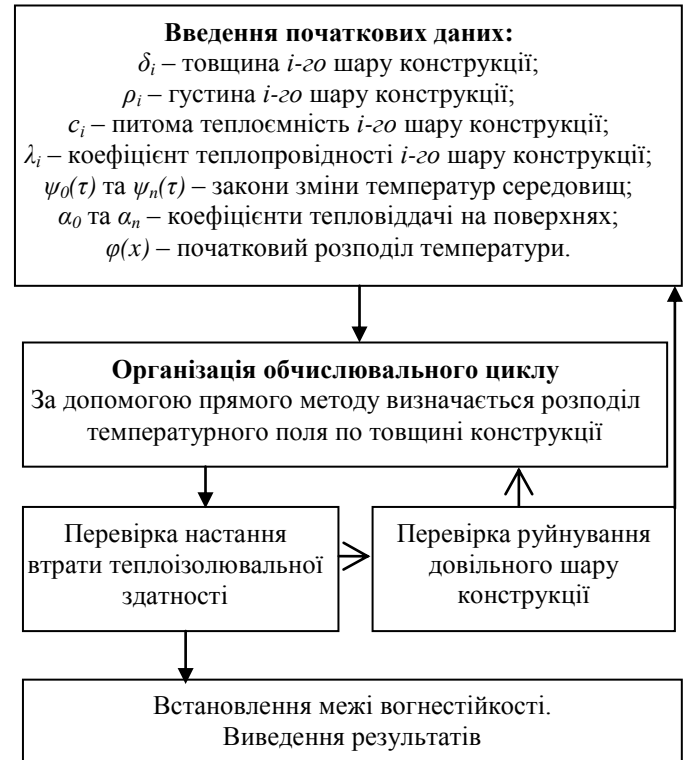
Рисунок 1 – Алгоритм обчислення втрати теплоізолювальної здатності з урахуванням руйнування довільного шару
