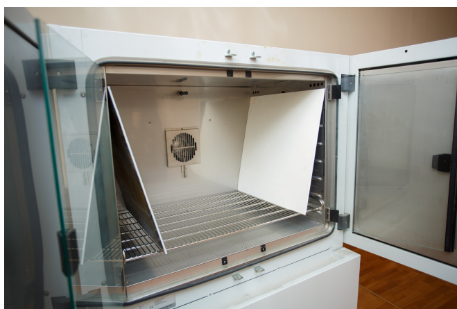
Рис. 1. Проведення експериментальних досліджень (а – проведення пришвидшених кліматичних випробувань вогнезахисного покриття в кліматичній камері BINDER KBF 240; б – підготовка зразків до вогневих випробувань)
