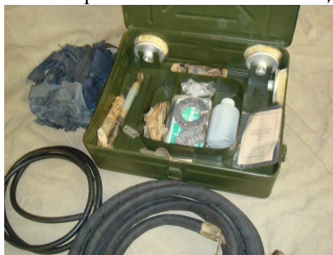
Рис. 1. Автомобільний комплект для спеціальної обробки військової техніки ДК-4
